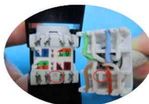
5. Drücken Sie den Kamm auf den IDC und stellen Sie sicher, dass die Drähte tief genug in den IDC Slots sitzen.
