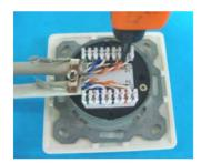
5. Richten Sie der Aussparung in der rückseitigen Abdeckung entsprechend der Kabel aus. Achten Sie darauf, dass die Nase an der Abdeckung in das Loch in der Dose passt (siehe Abbildung). Schließen Sie die Abdeckung und ziehen Sie die Schraube fest.
